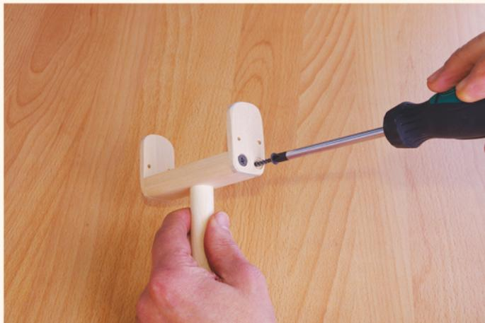
Шурупами крепим к корпусу трещотки боковины.
