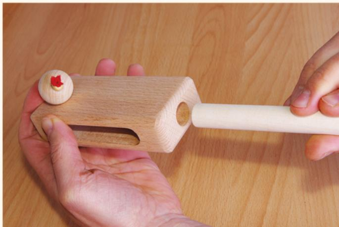
Предварительно смазав клеем ПВА отверстие в колотушке,
